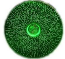
**Principe du contrôle** : La pièce est soumise à un flux magnétique qui est dévié en présence d'un défaut. Cette fuite attire les particules du produit révélateur et révèle la signature du défaut.
